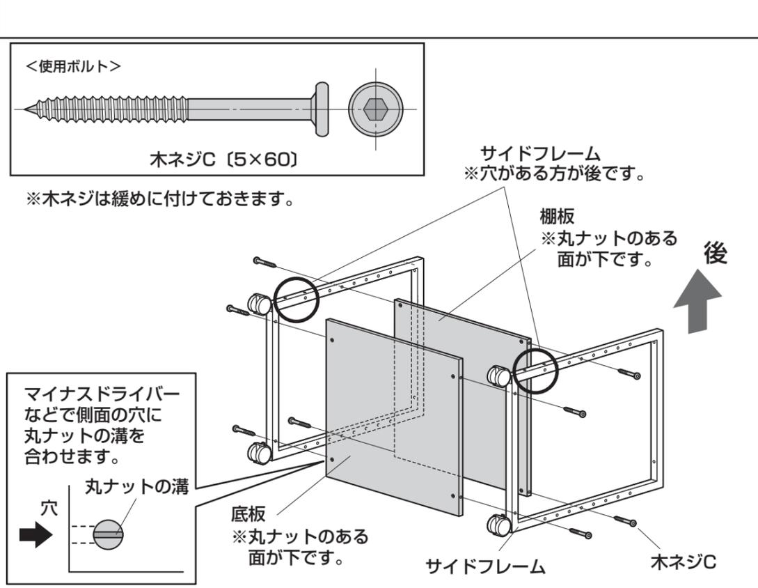
3. サイドフレームにバックパネルを取付けます。
